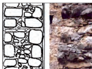
Fig. 3.1 – Pc: sezione a paramenti ben collegati o ad unico paramento (sezione piena)
